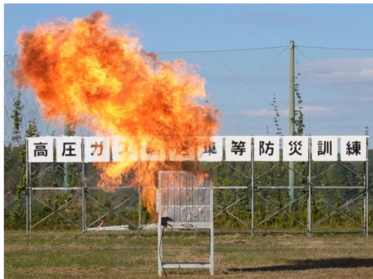
【カートリッジ缶の破裂により、LPガスはこのような燃え広がります！】
