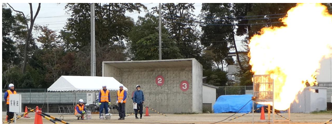
【カートリッジ缶の破裂により、LPガスはこのようなように燃え広がります】
